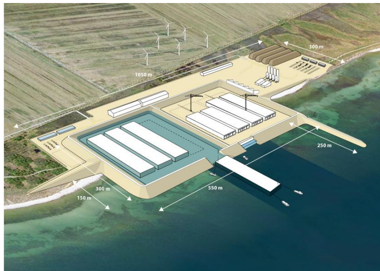
Beispiel eines traditionellen Baudocks für Tunnelelemente
